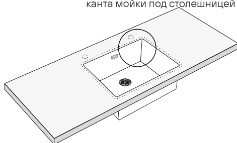
мойка установлена способом подстольного монтажа
